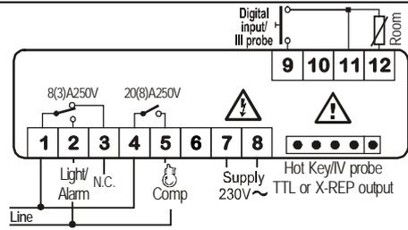
9-40Vdc: conectar l'alimentación a los terminales 7 y 8.
