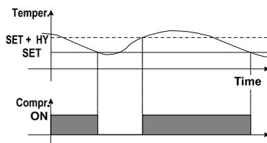
La regulación se realiza de acuerdo a la temperatura medida por la sonda termostática con un diferencial positivo respecto del punto de intervención (set point): si la temperatura aumenta y alcanza el valor del punto de intervención más el diferencial el compresor arranca para detenerse cuando la temperatura alcanza nuevamente del valor correspondiente al punto de intervención.
