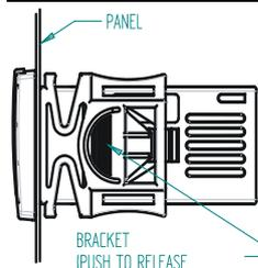
Los instrumentos deben ser montados en panel, en una perforación de 29x71 mm, y fijados usando las fijaciones que se acompañan.
